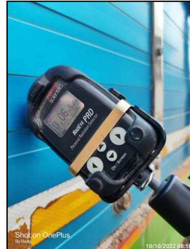
ภาพที่ 2.13 การตรวจสอบสารกัมมันตภาพรังสีด้วย Radiation Meter
